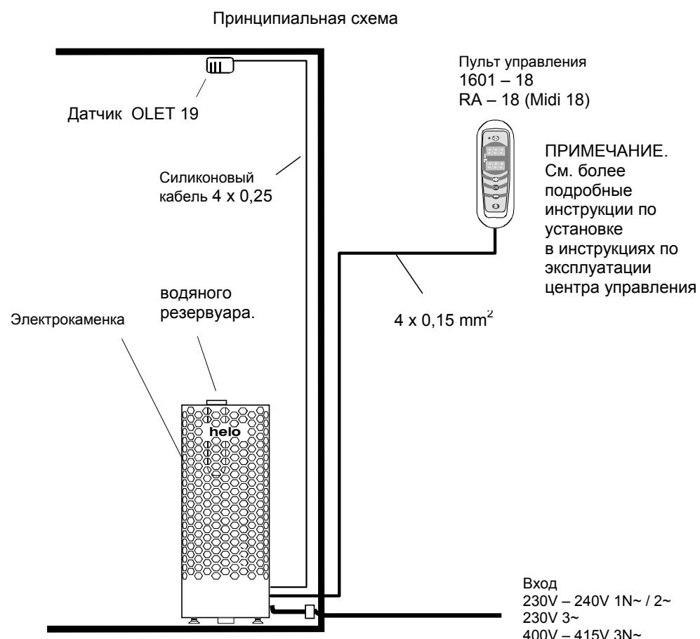
Рис 6 Принципиальная схема
